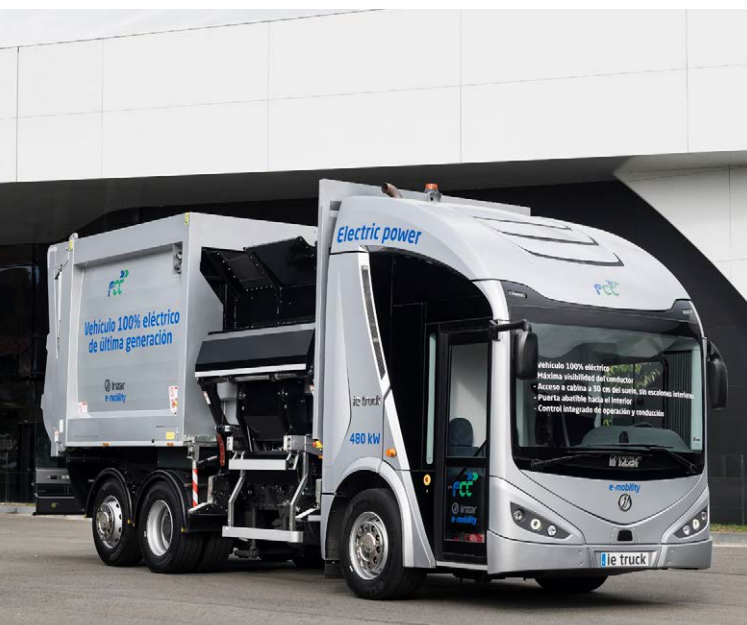
Vehículo recolector eléctrico de carga lateral desarrollado sobre la plataforma FCC de e-movilidad.
